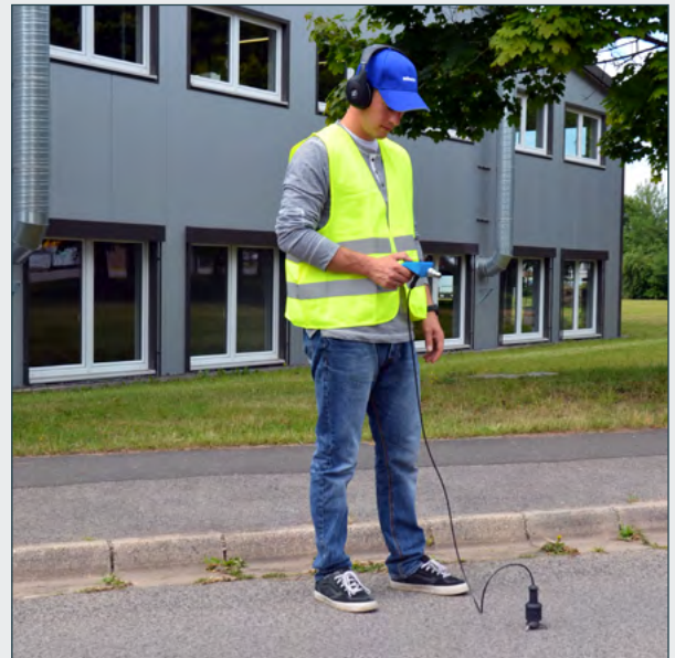
Punktortung mit HL 50-BT und PAM B-2 Universalmikrofon
