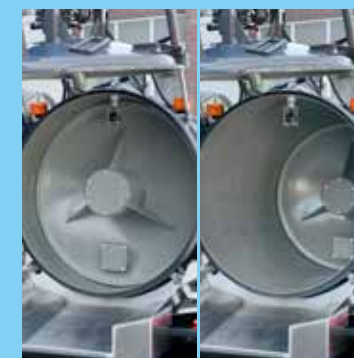
Verschiebbare Tanktrennwand zur Kapazitätssteigerung
