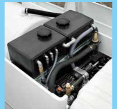
Frischwassertanks aus Polyethylen, um Gewicht zu reduzieren
